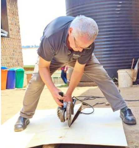
Holzzuschnitt mit Winkelschleifer und einer riskanten Stromverbindung.
